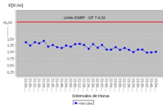
Figura 4. Cuadro comparativo con las normativas ICNIRP y UIT T-K.52 del valor máximo, mínimo y medio de campo eléctrico del rango de 21:00 a 23:54 del día miércoles.
