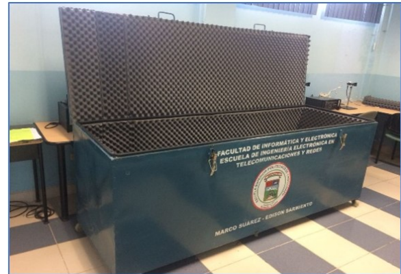
Figura 2. Implementación de la Cámara Anecoica.
